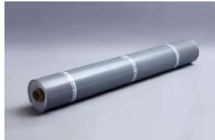
**实例 2** 东方雨虹隔热自粘沥青防水卷材区别于普通的外露型防水卷材，厚度更薄（≤2.0mm），采用自粘法施工，无需耗用热源，且卷材表面采用白色隔热膜，能有效的反射光和热（夏季晴天测试屋面温度可降低 25%），能更好的保护沥青层，延长防水卷材寿命。有效减少室内夏季制冷和冬季制暖造成的能源损耗，减少碳排放。
