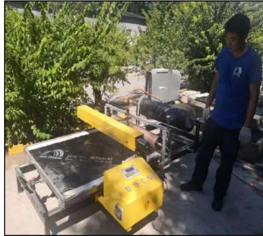
SBS 改性沥青卷材恒定热熔试验机
